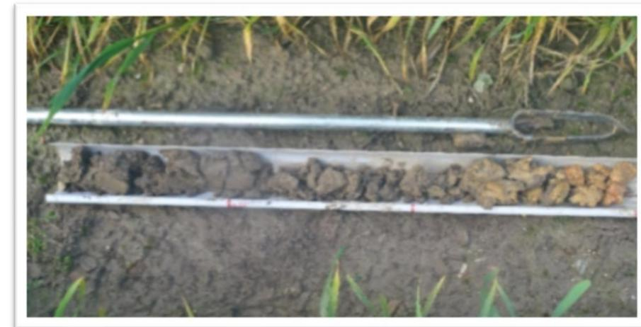
Photo 89 : exemple de carottage sur une profondeur de 120 cm
